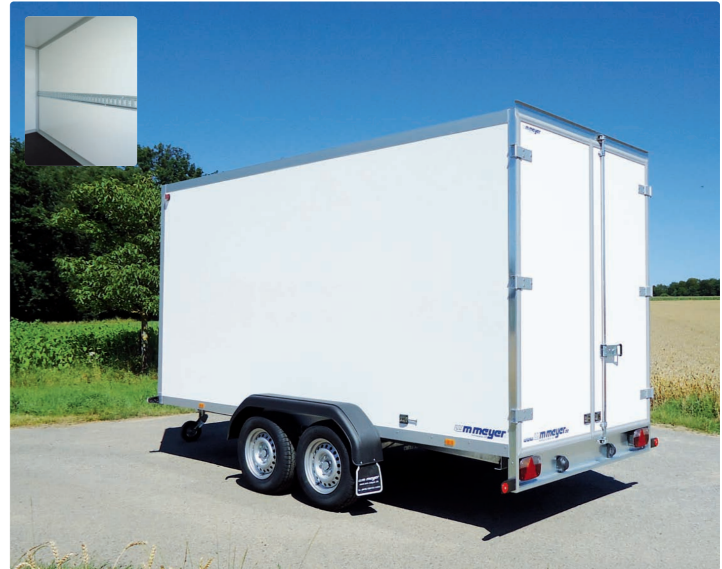
AZ 2740/185 Serie 35 Verstärkungen mit Filzstift angezeichnet; kleines Bild: Zurrleiste (Serie bei Innenlänge von 3.010 mm) AZ 2740/185 Série 35 Renforts indiqués avec stylo à feutre ; petite image : rail de fixation (en série : longueur intérieure de 3.010 mm) AZ 2740/185 Series 35 Reinforced sections indicated with felt pen; small picture: lashing rail (standard for interior length of 3,010 mm)
